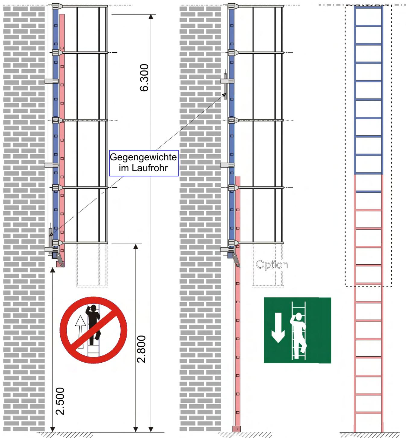
Exakt vorbereitete Leiterstöße mit Steckelementen in den Leiterholmen erleichtern den Zusammenbau mit Sicherheitsverschraubung in V2A. Die Leiter wird aus Rohrholmen mit abgerundeten Außenkanten (75 x 26 x 2 mm) und extrudierten Sprossen vom Typ "Omega" mit tiefen rutschfesten Riefungen auf der Oberseite hergestellt.
