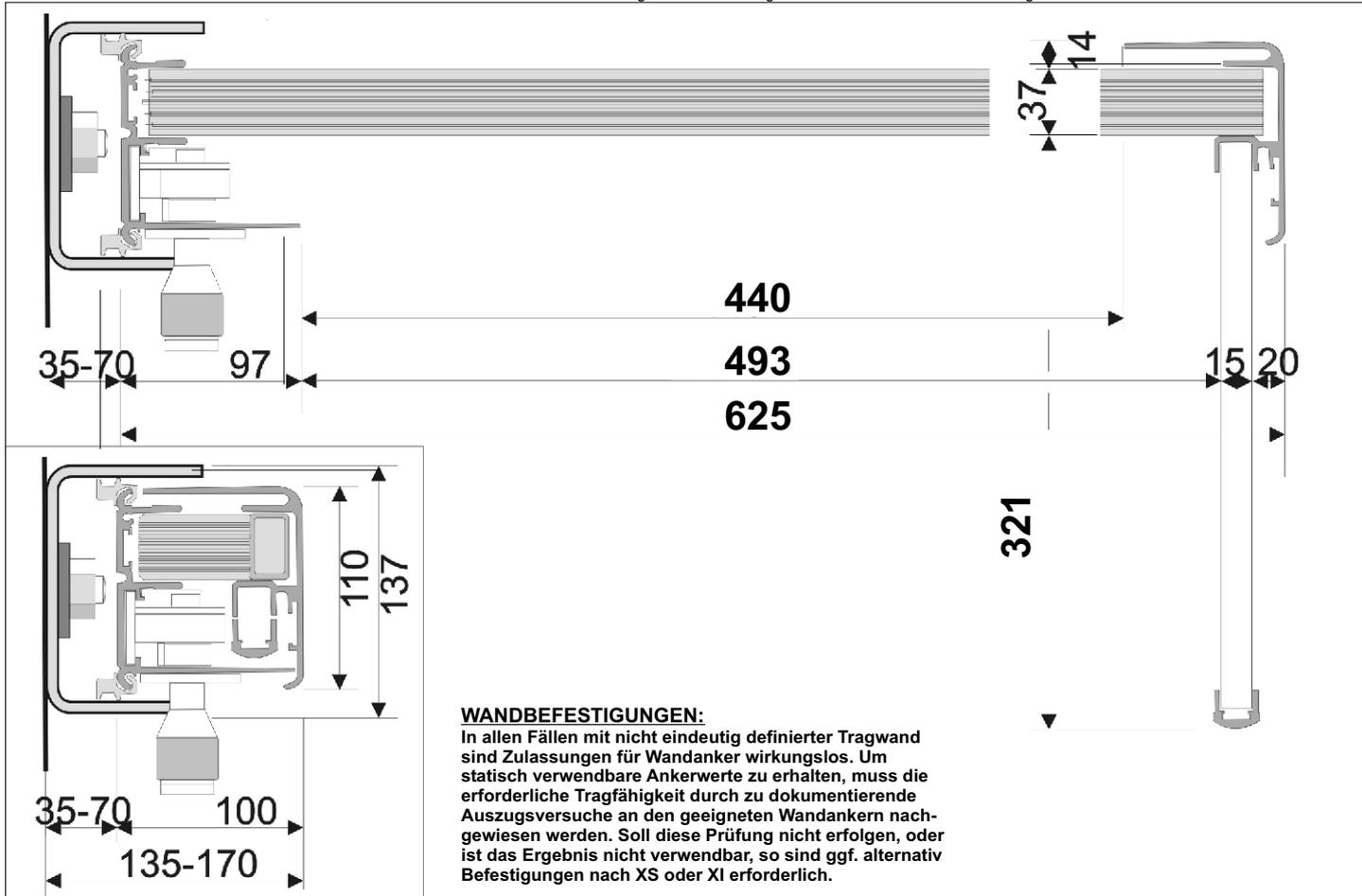
**BS:** Beton-Standard; Tragwand: Beton B25 oder B45; Befestigung: Ankerstange + zugel. Beton-Anker
