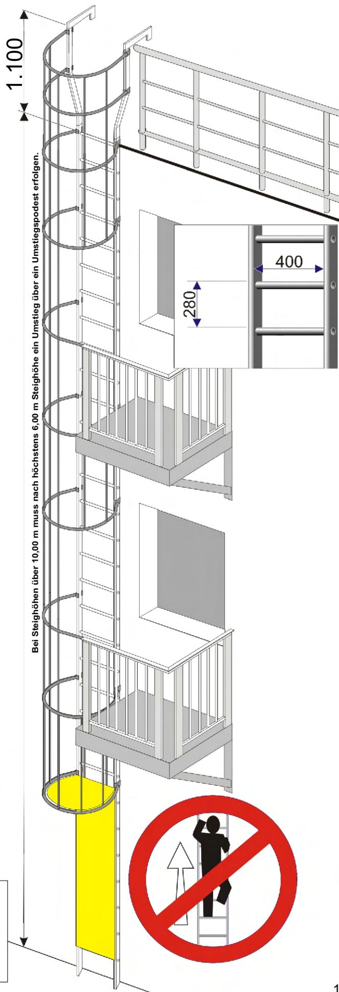
Bei Steighöhen über 10,00 m muss nach höchstens 6,00 m Steighöhe ein Umstieg über ein Umstiegspodest erfolgen.
